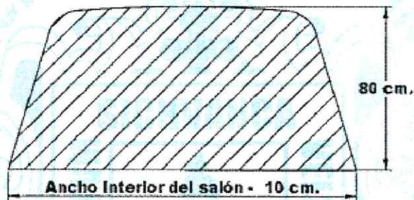
5. El panel debe ir instalado detrás de la primera fila de asientos y fijado a la estructura del vehículo con mínimo 4 anclajes en L.
